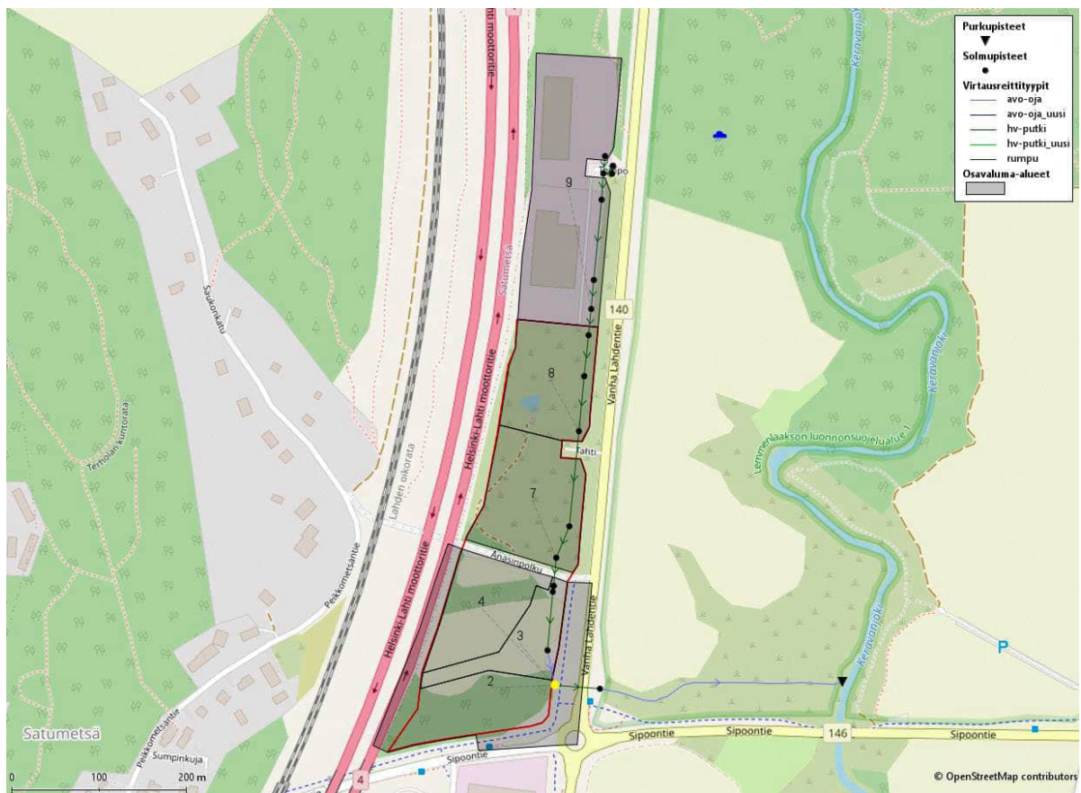
Kuva 30 Nykytilanteen hulevesimalli. Keltaisella merkitty piste, jossa huippuvirtaamia on tarkasteltu nykyisessä ja tulevassa tilanteessa. Punaisella rajattu suunnittelualue.
