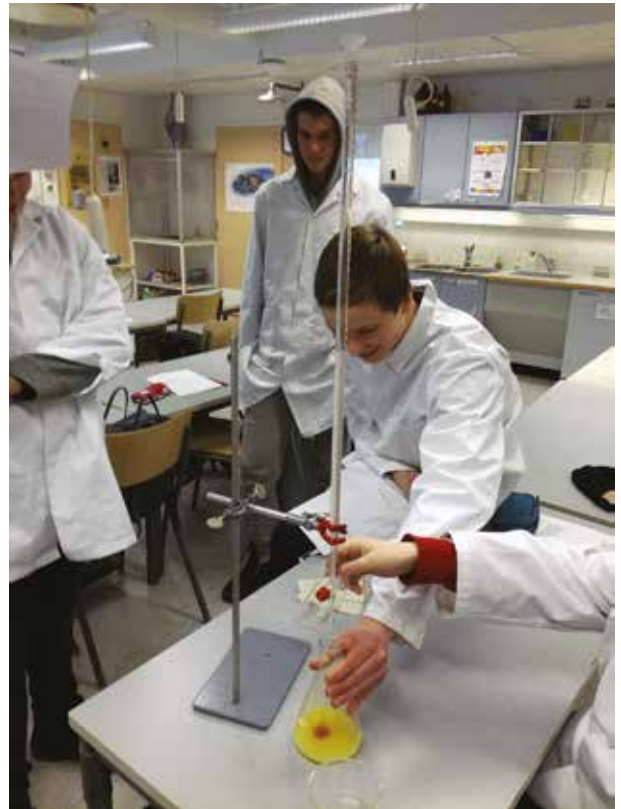
Tässä mitataan lauantaimakkaran suolapitoisuutta saostustitrauksen avulla.
