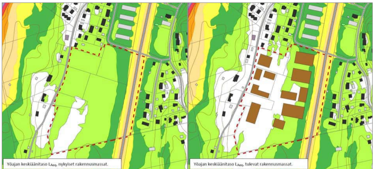
Kuva 6. Yöaikaiset keskiäänitasot L_{Aeq} nykyisillä ja tulevilla rakennusmassoilla.
