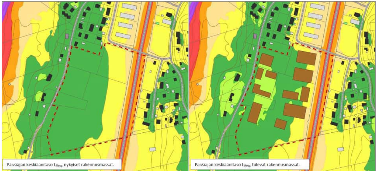
Kuva 5. Päiväaikaiset keskiäänitasot L_{Aeq} nykyisillä ja tulevilla rakennusmassoilla.
