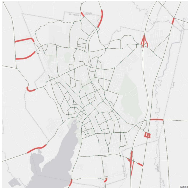
Kuva 3. Liikennemallin liikenneverkon nykytilaa kuvaava kuva, johon on punaisiin rajamerkinneihin havainnollistettu kohdat, joiden ylittävän liikenteen on katsottu olevan saapuvaa, lähtevää tai läpikulkevaa.
