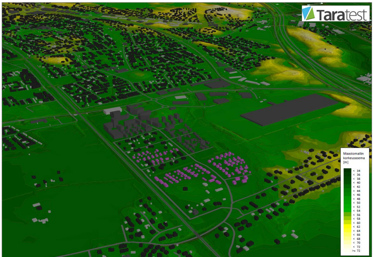
Kuva 4. Ote laskennassa käytetystä maastomallista sekä huomioidut rakennusmassat.
