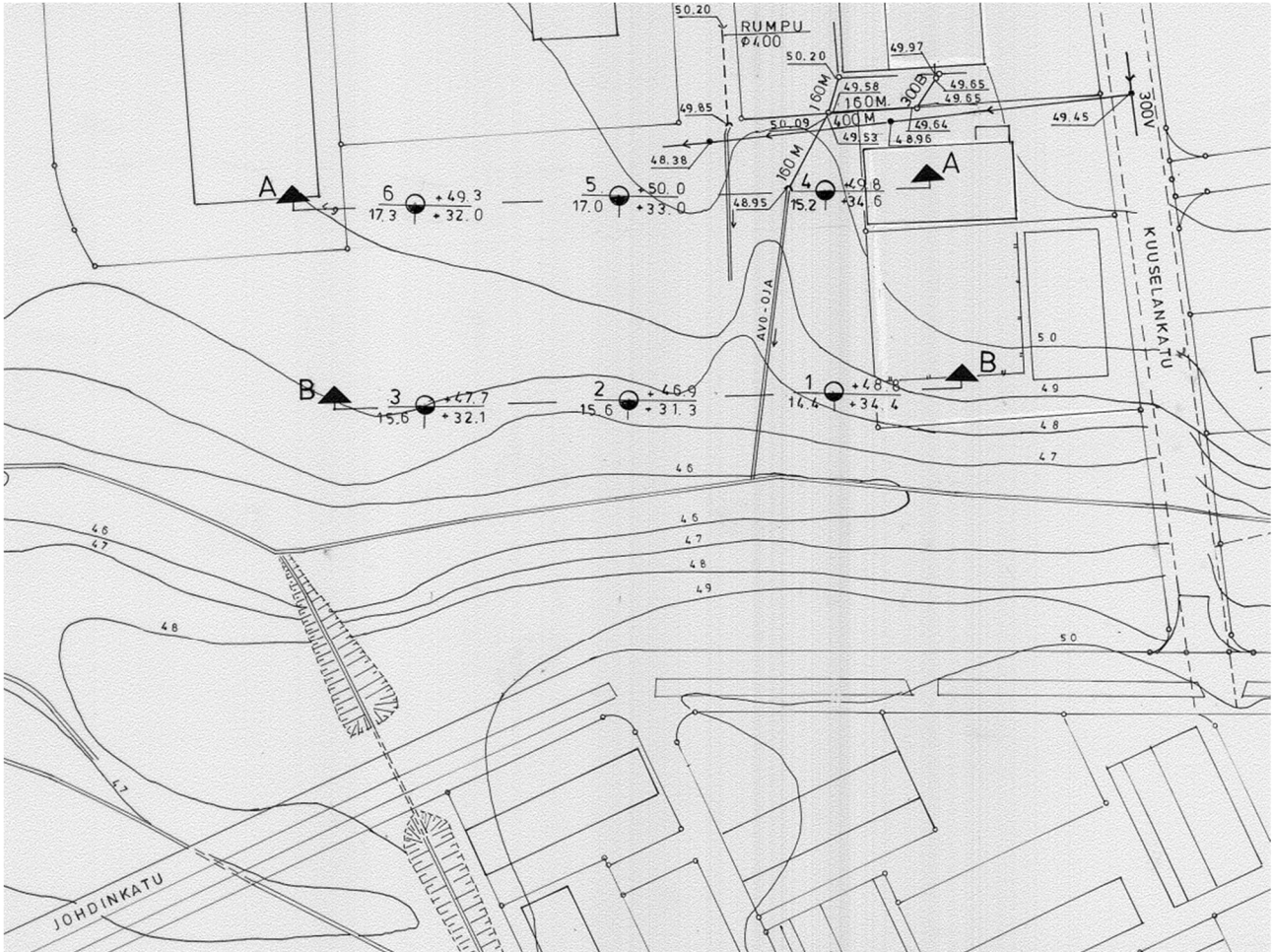
Kuvaote tennishallien eteläpuolelle tehdyistä pohjatutkimuksista.
